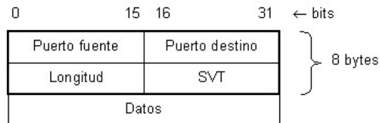
Figura 27-1: Formato de la cabecera del protocolo UDP
