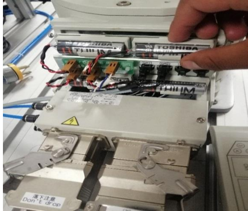
Figura 29-2: Suministro de voltaje a Brazo Robótico
