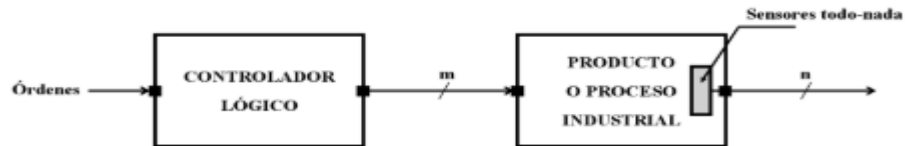
Figura 20-1: Conexión de un controlador lógico a un producto o un proceso industrial
