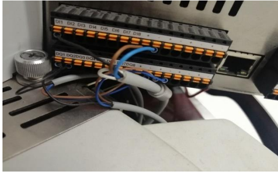
Figura 33-2: Conexión a entradas digitales
