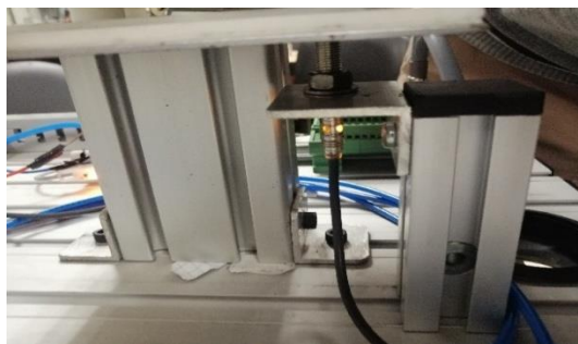
Figura 24-2: Colocación de sensores para detectar pallets
