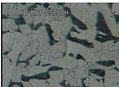
Figura 2.10: Material Base atacado químicamente con 0.5% ácido Hidrofluórico. Estructura con presencia de Ferrítica en las zonas claras y Perlita en las zonas oscuras
