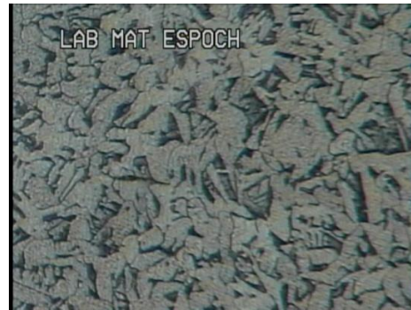
Figura 2.13: Soldadura atacado químicamente con 0.5% ácido Hidrofluórico. Estructura con presencia de Ferrítica en las zonas claras y Perlita en las zonas oscuras. Zoom 20x
