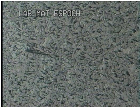
Figura 2.12: Soldadura atacado químicamente con 0.5% ácido Hidrofluórico. Estructura con presencia de Ferrítica en las zonas claras y Perlita en las zonas oscuras. Zoom 10x
