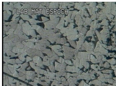
Figura 2.9: Material Base atacado químicamente con 0.5% ácido Hidrofluórico. Estructura con presencia de Ferrítica en las zonas claras y Perlita en las zonas oscuras. Zoom 10x
