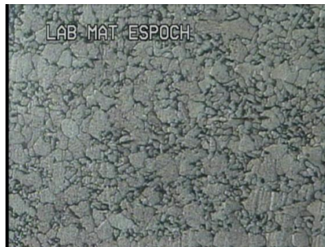
Figura 2.15: Material Base + Soldadura atacado químicamente con 0.5% ácido Hidrofluorico. Estructura con presencia de Ferritica y Perlita- Zoom 10x
