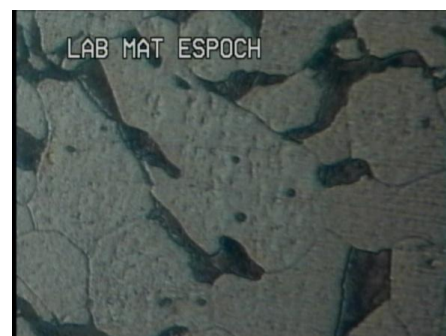
Figura 2.11: Material Base atacado químicamente con 0.5% ácido Hidrofluórico. Estructura con presencia de Ferrítica en las zonas claras y Perlita en las zonas oscuras Zoom 40x
