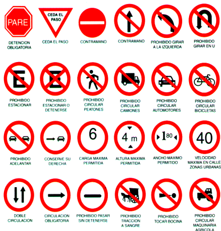
Figura 9 – 2. Señales de reglamentación
