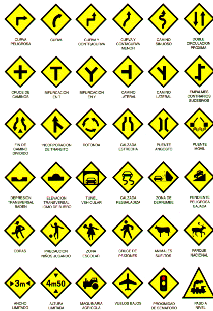
Figura 10 – 2. Señales de prevención
