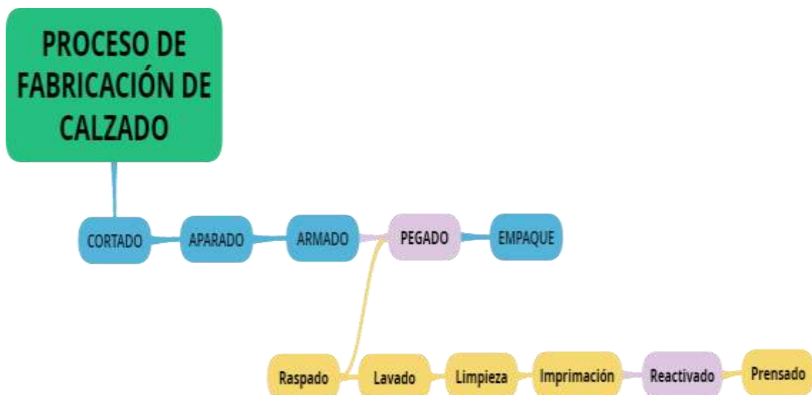
Gráfico 1 – 2: Diagrama del proceso de producción del calzado Realizado por: CAISAGUANO, Washington, 2018
