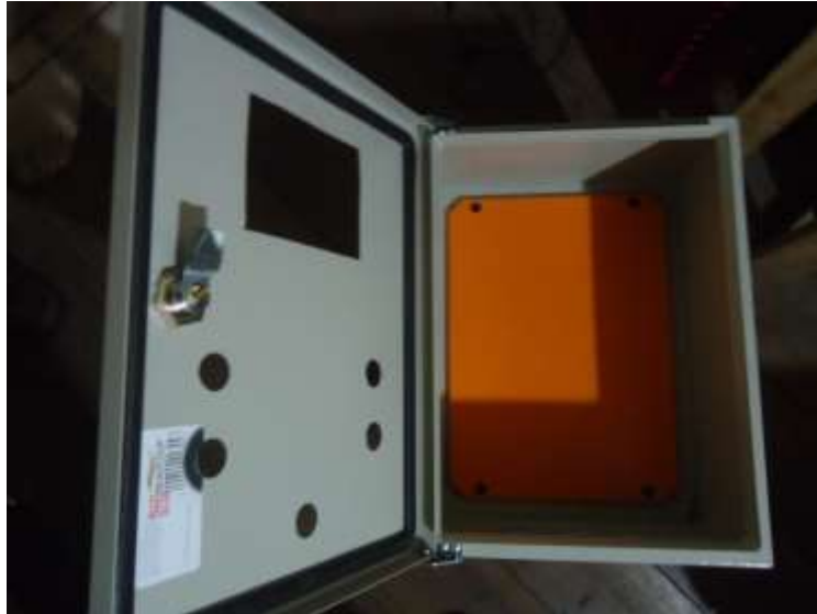
Figura 26 – 2: Gabinete para el tablero de control con IP46. Realizado por: CAISAGUANO, Washington, 2018
