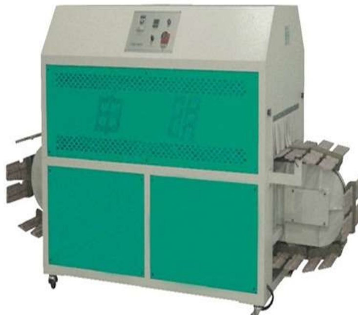
Figura 2 - 1: Horno para secado y activado de pegamento para suela modelo EM-EZD2028.
