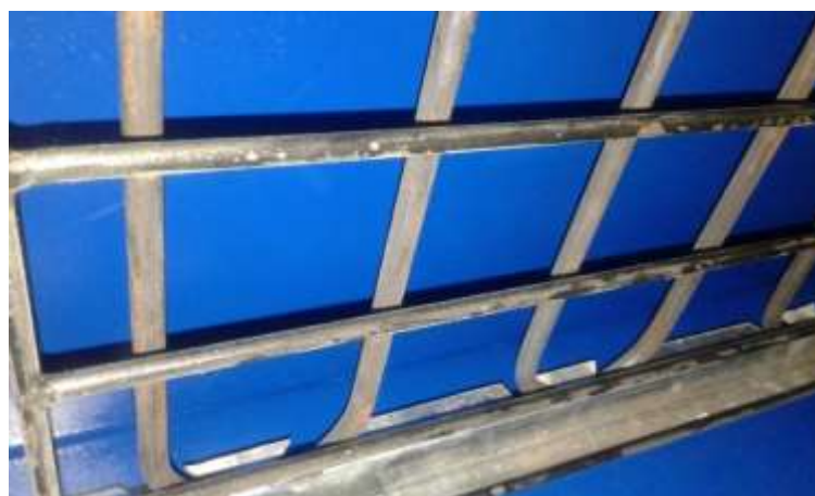
Figura 4 – 2: Ubicación de las niquelinas dentro del reactivador Realizado por: CAISAGUANO, Washington, 2018
