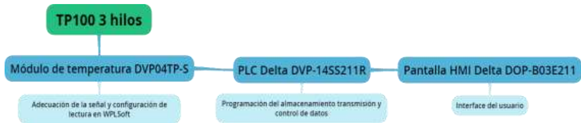
Gráfico 4 – 2: Diagrama de adecuación del TP100 de 3 hilos para el control
