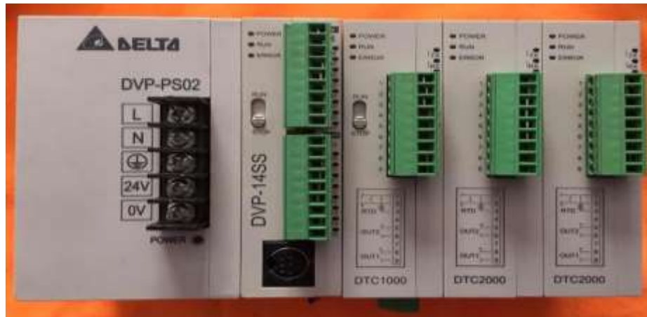
Figura 20 - 1: PLC delta con fuente y módulos control de temperatura Fuente:// http2.mlstatic.com/plc-delta-fuente-modulos-control-de-temperatura-D_NQ_NP_713683-MLA28984791687_122018-F.jpg
