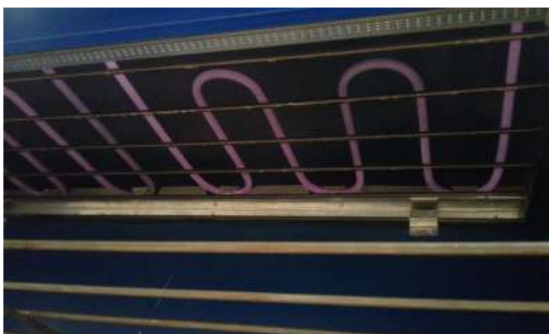
Figura 3 – 3: Calentamiento de las niquelinas internas del reactivador. Realizado por: CAISAGUANO, Washington, 2018
