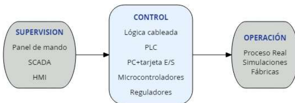
Figura 21 - 1: Esquema general de un sistema automatizado
