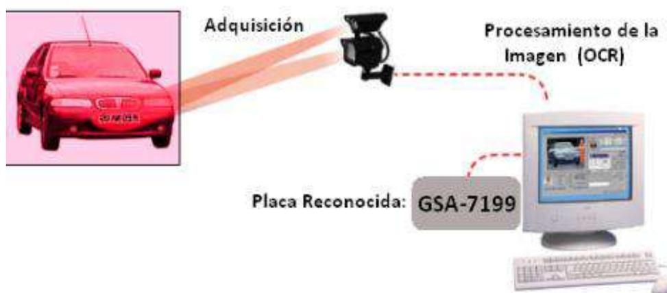
**Figura 2-1:** Componentes de un Sistema ANPR.
