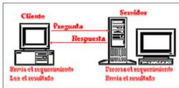
**Figura 1-1:** Modelo cliente/servidor.
