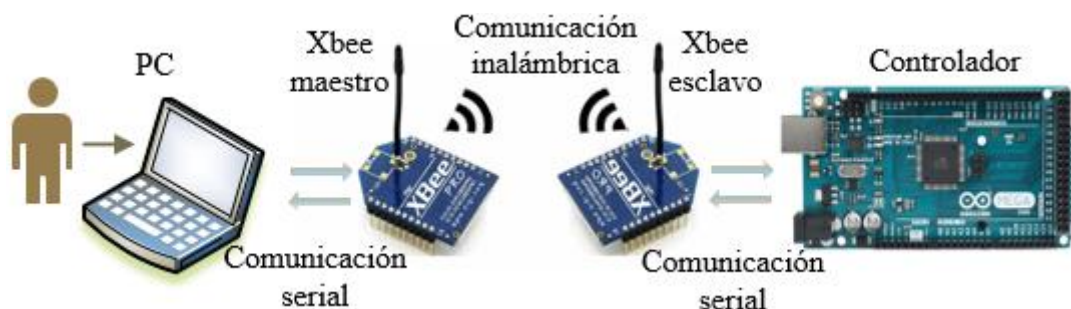
Figura 10-3. Estructura comunicación de los dispositivos del prototipo.
