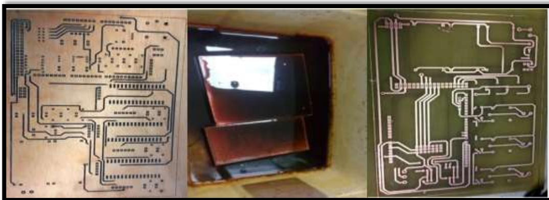
**Figura 34-2** Proceso químico para realización de PCB
