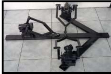
**Figura 13-2** Ensamble mecanismo motor y base del chasis
