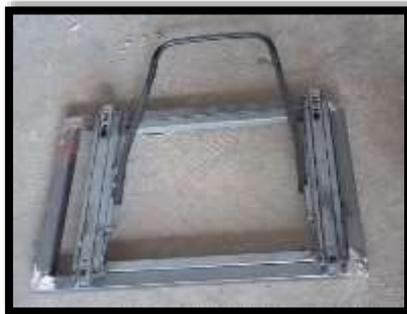
**Figura 14-2** Estructura base para el asiento
