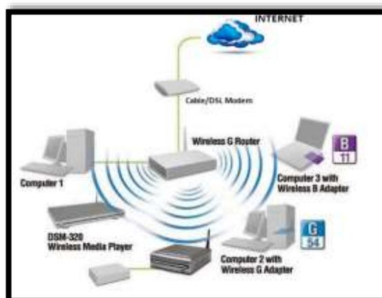
**Figura 21-1:** Funcionamiento de una red inalámbrica
