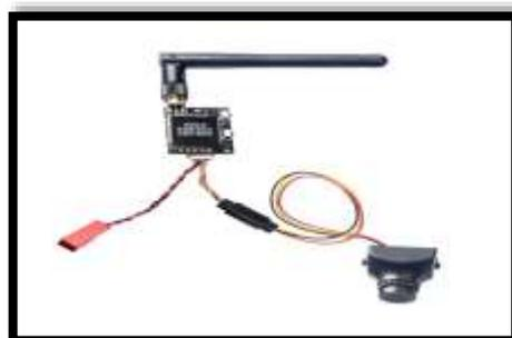
**Figura 23-2** Cámara y transmisor FPV
