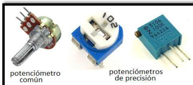
**Figura 9-1:** Aspecto físico de la resistencia variable
