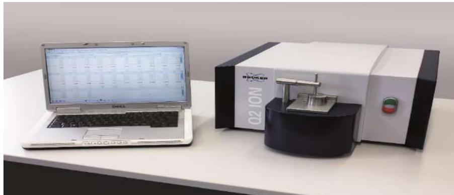
**Figura 3-3:** Espectrómetro Bruker Q2ION
