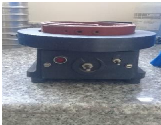
Figura 13-3. Agitador mecánico empleado para tamizar del NaCl.
