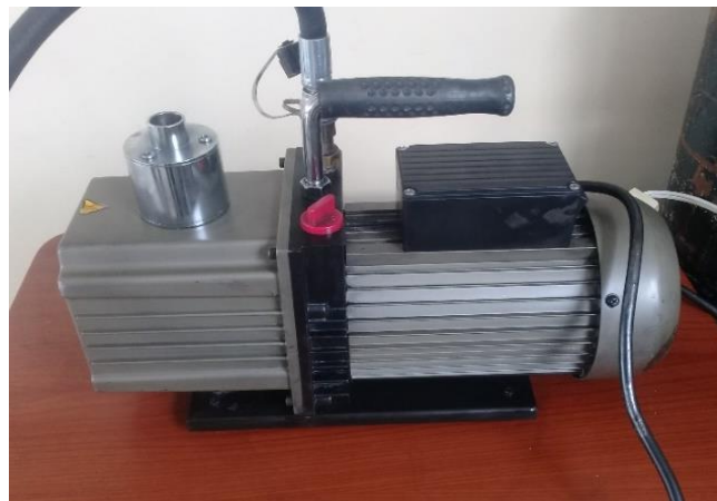
Figura 6-3. Bomba de vacío QUALITY Model QVP 800, utilizada en el experimento.
