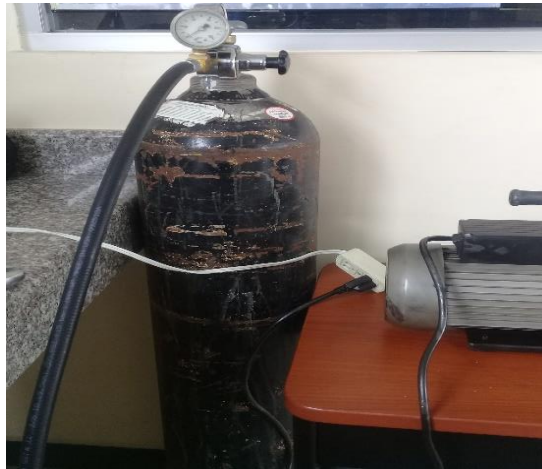
Figura 7-3. Tanque de gas argón presurizado.
