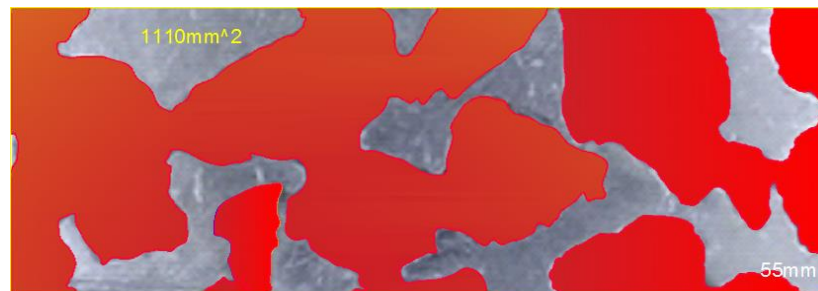
Figura 11-4. Porcentaje de porosidad (espuma metálica de celda abierta) determinada en una área de 1100 \text{ mm}^2 .
