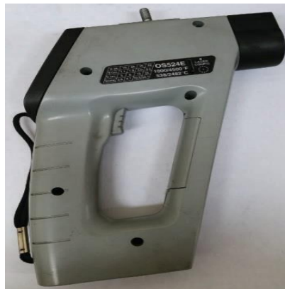
Figura 11-3. Pirómetro utilizado en la medición de la temperatura del molde cilíndrico.
