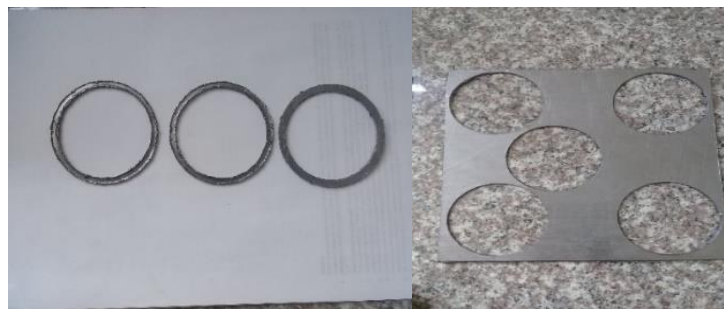
Figura 9-3. Lámina de grafito utilizada como material sellante.
