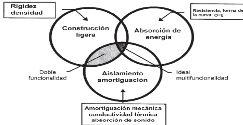
Figura 24-2: Principales campos de aplicación automotriz de espumas metálicas estructurales.
