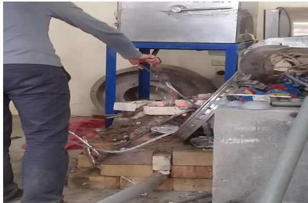
Figura 3-3. Horno de crisol utilizado para fundir el aluminio puro.
