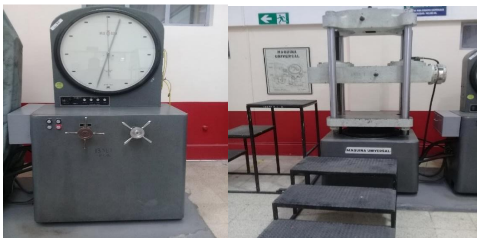
Figura 12-4. Máquina universal de ensayo de compresión uniaxial del laboratorio de resistencia de materiales de la facultad de mecánica de la ESPOCH
