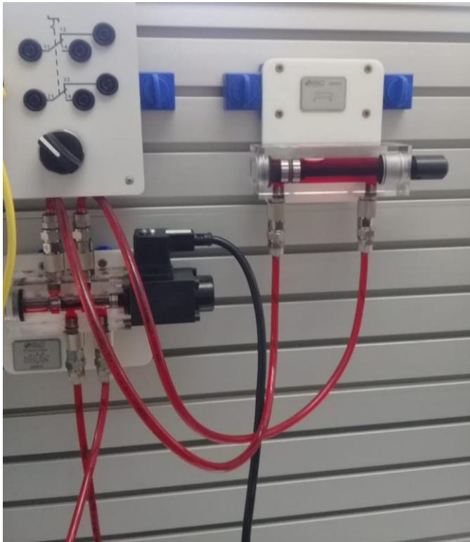
Figura 3-4. Funcionamiento del cilindro de doble efecto.
