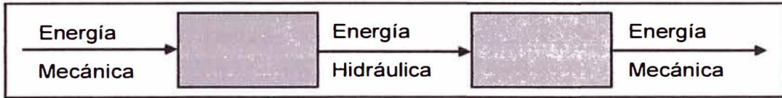
Figura 1-2. Transformación de energía en sistemas hidráulicos
