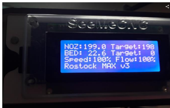
Figura 14-33: Configuración para impresión 3D Realizado por: Velasco Pilco, Jenny Liliana, 2019
