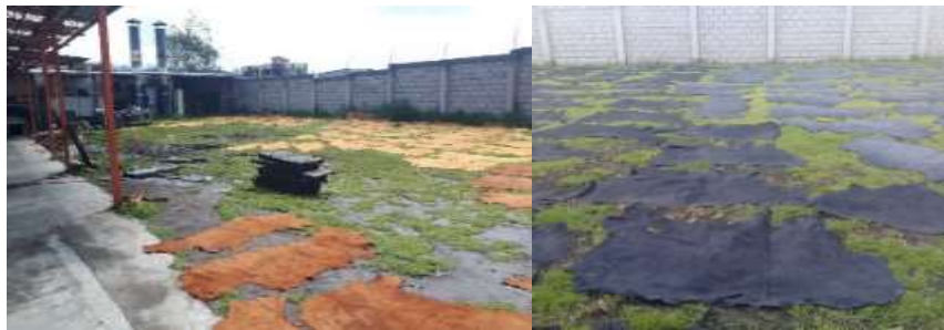
Figura 15-3. Secado al ambiente Fuente: Curtiembre Quisapincha, 2019
