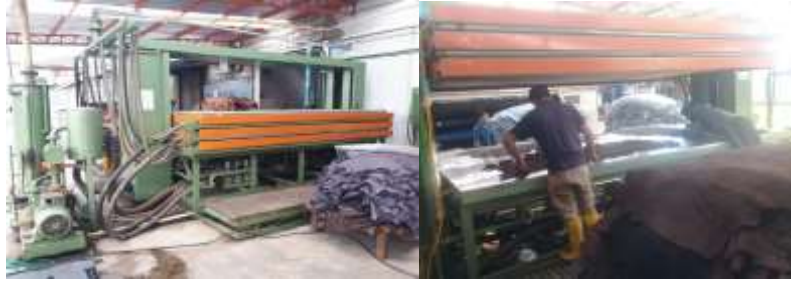
Figura 14-3. Secado al vacío Fuente: Curtiembre Quisapincha, 2019
