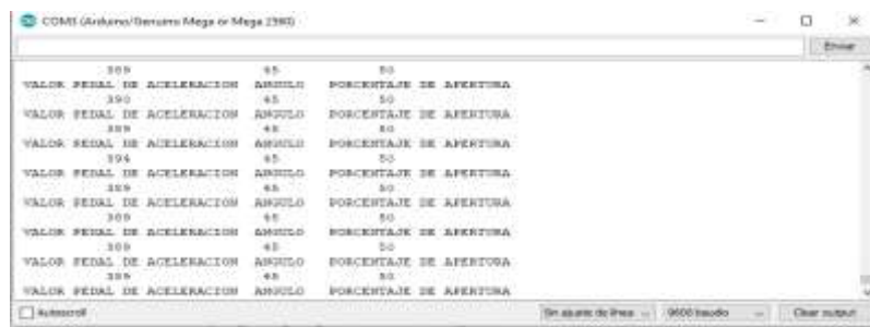
Figura 28-2. Ángulo de apertura y su equivalencia en porcentaje Realizado por: (Gabriela Noroña, Alex Venegas, 2019)
