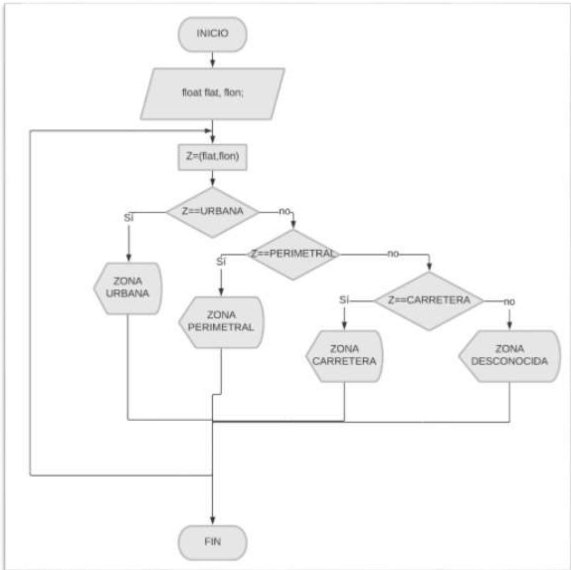
Figura 26-2. Diagrama de flujo para el reconocimiento de zona Realizado por: (Gabriela Noroña, Alex Venegas, 2019)
