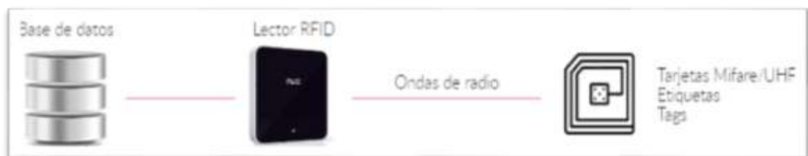
Figura 12-1. Esquema de funcionamiento de un sistema RFID
