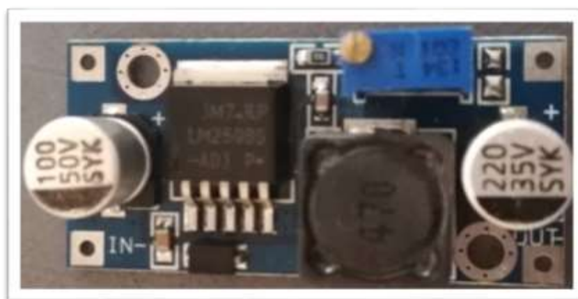
Figura 18-2. Fuente reductora 12V a 5V
