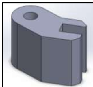
Figura 41-2: Soporte móvil para cristal reflectante Realizado por: MACHADO, Edwin, 2019
