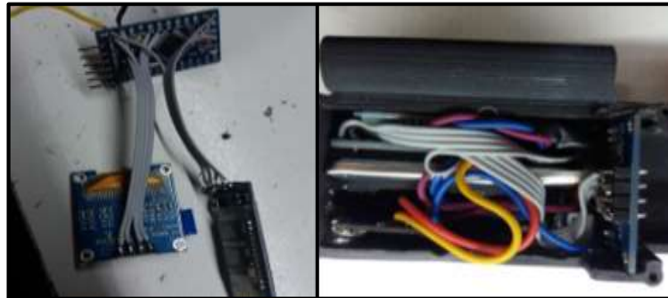
Figura 52-2: Implementación del HMD monocular Realizado por: MACHADO, Edwin, 2019
