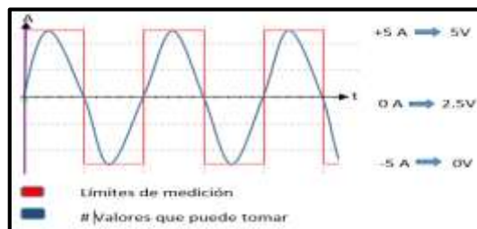
Figura 21-2: Valores de operación para corriente Realizado por: MACHADO, Edwin, 2019
