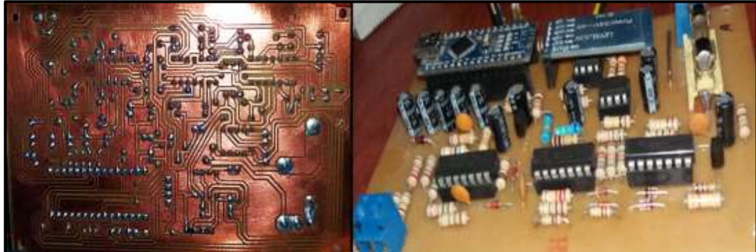
Figura 50-2: Vista posterior y frontal de la placa PCB del transmisor Realizado por: MACHADO, Edwin, 2019
