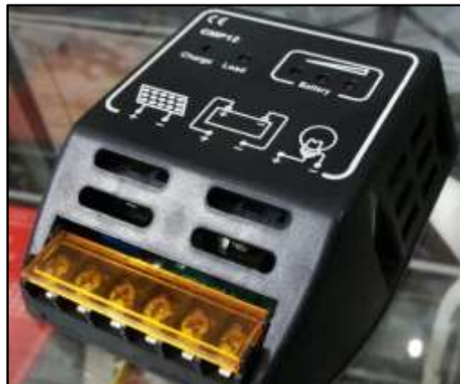
Figura 7-2. Controlador Solar CMP12-10A. Elaborado por (Bone Valeria, 2019)
