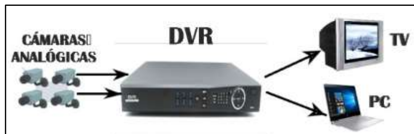
Figura 12-1. Funcionamiento DVR Elaborado por (Bone Valeria, 2019)
