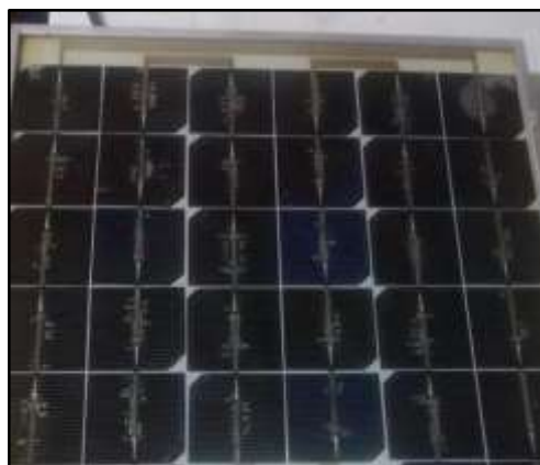
Figura 6-2. Panel Solar 50W. Elaborado por (Bone Valeria, 2019)
