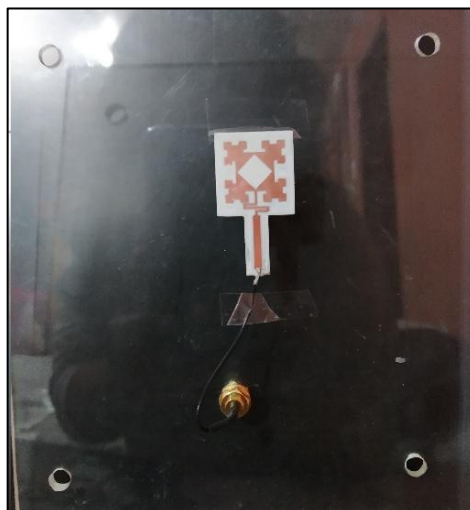
Figura 38-2. Antena implementada para pruebas
