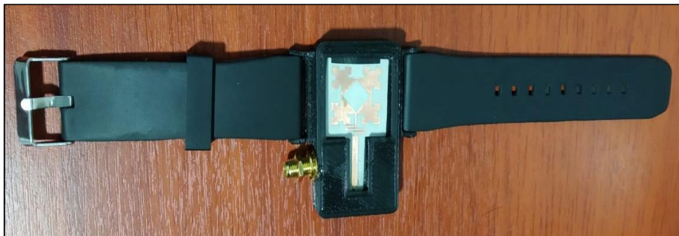
Figura 37-2. Prototipo de estructura de smartwatch con antena fractal microstrip
