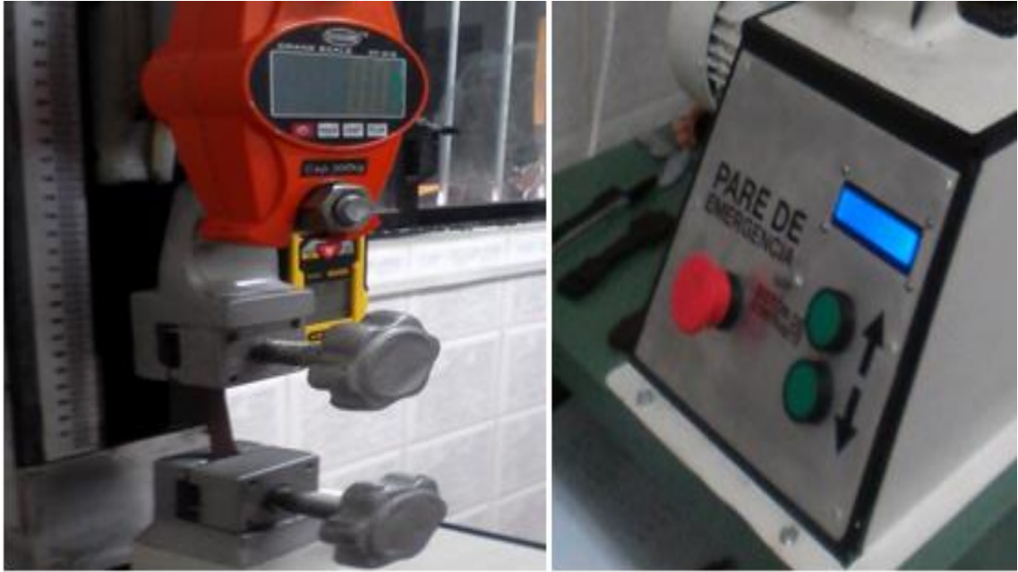
Fotografía 1- 2:Partes de un equipo para realizar la medición de la resistencia al frote en seco.
