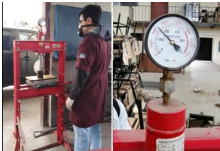
Figura 10-3: Compresión de la mezcla a 220 bares
