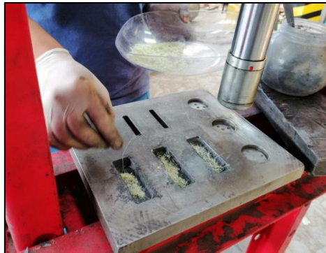
Figura 9-3: Colocación de la mezcla con la fibra de cabuya
