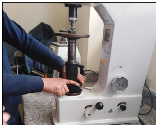
Figura 27-3: Aplicación de la carga principal
