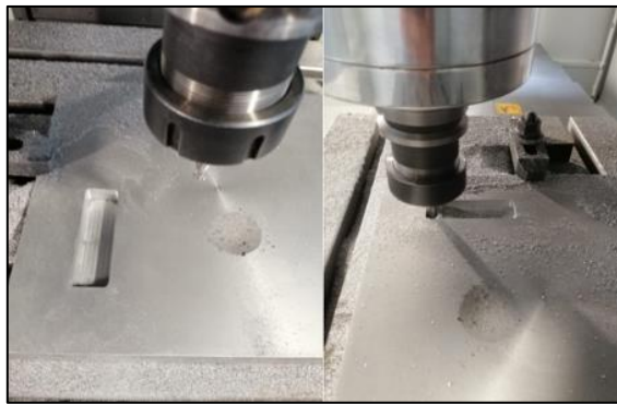
Figura 2-3: Mecanizado del molde de las probetas
