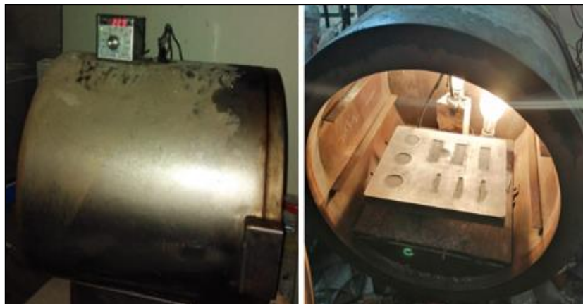
Figura 12-3: Colocación del molde en la mufla
