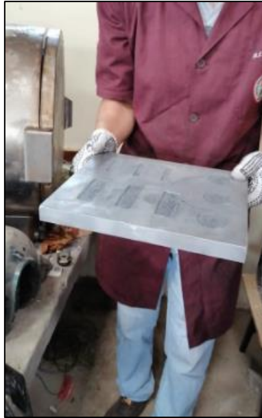
Figura 13-3: Retiro del molde dentro de 2 horas
