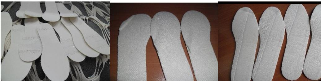
**Ilustración 8-4:**Proceso de troquelado
