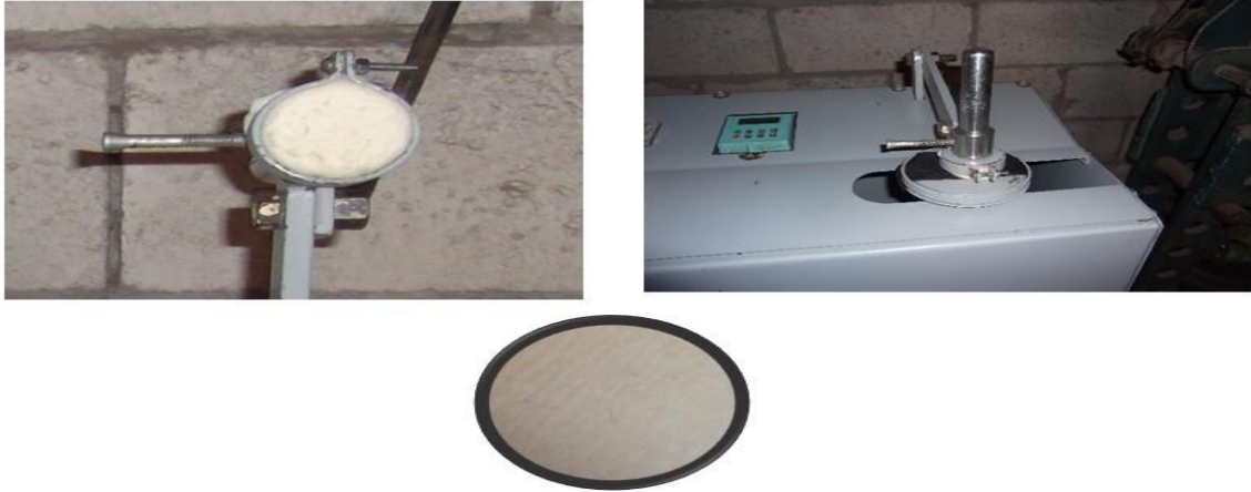
Fotografía 2-3: Forma de colocar el fieltro en el prototipo mecánico para la Medición de la resistencia al frote en seco del cuero.
