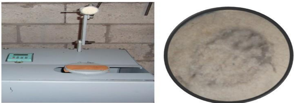
Fotografía 3-3: Fieltro manchado después de la medición de la resistencia al frote en seco realizado en el prototipo mecánico de la Facultad de Ciencias Pecuarias.
