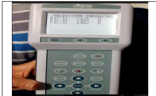
Sonómetro integrador tipo I, ponderación en leqS (A), LSmn (A), LSmx (A).
