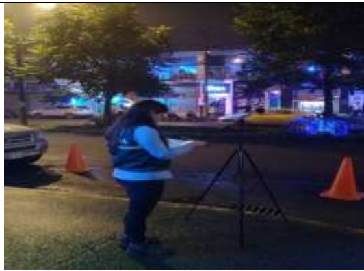
Sonómetro integrador tipo I, ponderación en leqS (A), LS_{mn} (A), LS_{mx} (A).
