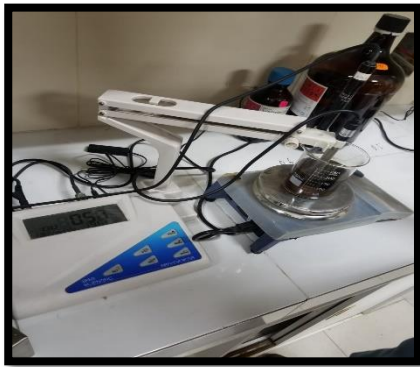
Control de pH del extracto bruto líquido
