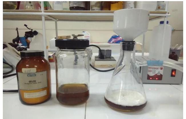
/ Filtración del agua de saponinas con zeolita
