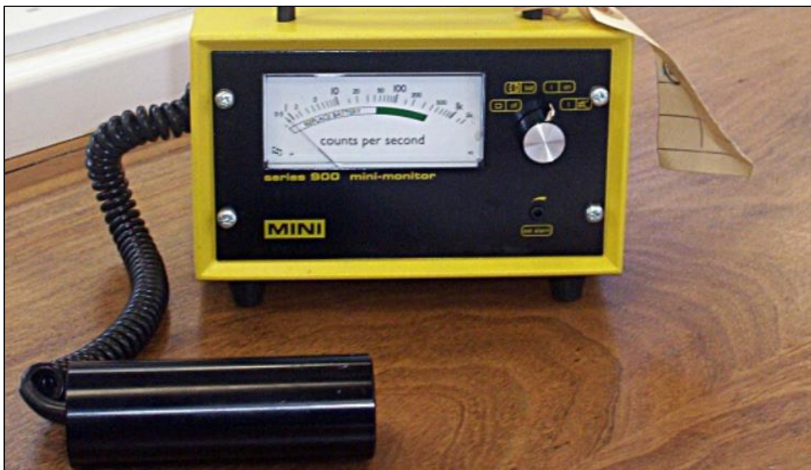
Figura 8-2: Contador Proporcional Fuente: ECURED, 2018
