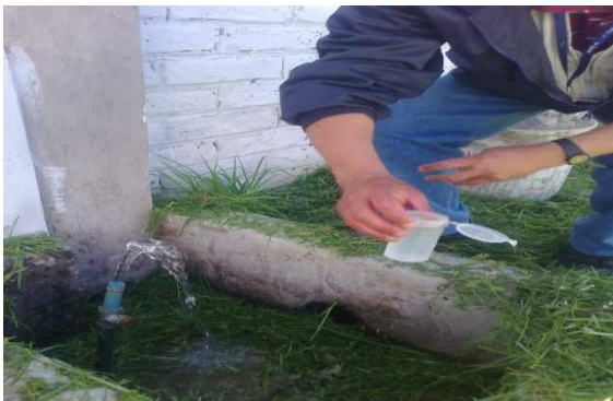
Fotografía 8-69: Recolección de la muestra de Agua en la Red de Distribución
