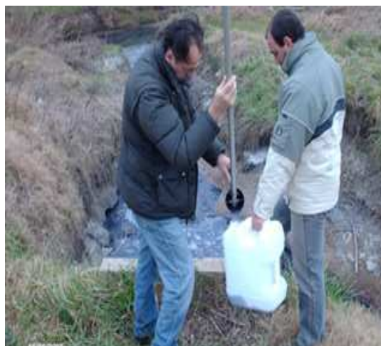
Fotografía 2-1: Recolección de la Muestra de Agua
