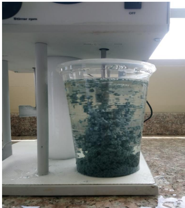
Figura 4-1: Pruebas de jarras coagulación-floculación
