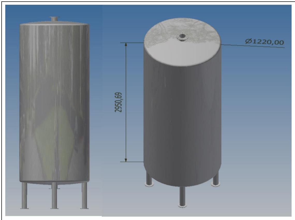
**Figura 14- 3:** Filtro de flujo descendente (FT-001). Dimensiones en mm.
