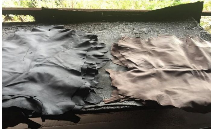
Fotografía 9-3: Cuero curtido con cromo comercial (negro) y cromo reciclado (café), producto terminado.
