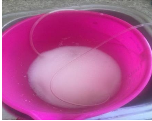
Fotografía 14-3: Proceso de aeración para el tratamiento del agua residual de pelambre.
