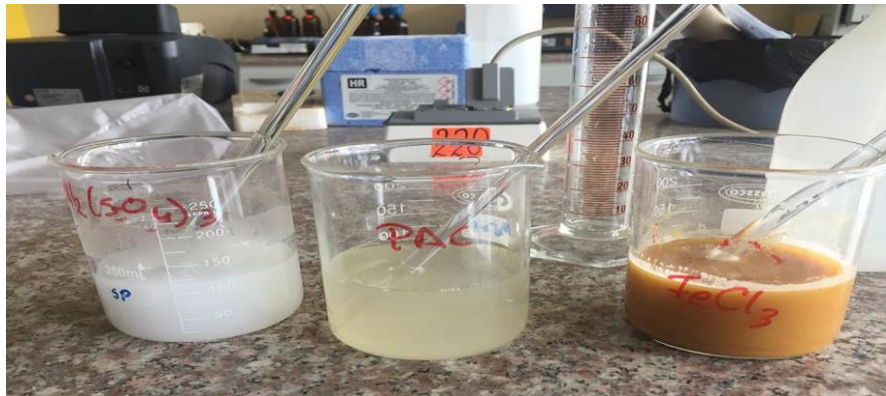
Fotografía 1-3: Dosificación de los diferentes coagulantes añadidos para el tratamiento del agua residual producida en la curtiembre pieles “PUMA”
