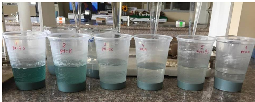
Fotografía 2-3: Selección del pH óptimo para el proceso de coagulación-floculación del agua residual de curtido.
