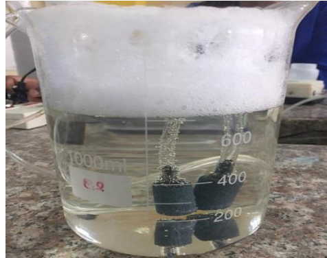
Fotografía 6-3: Proceso de aeración para el tratamiento del agua residual de curtido.
