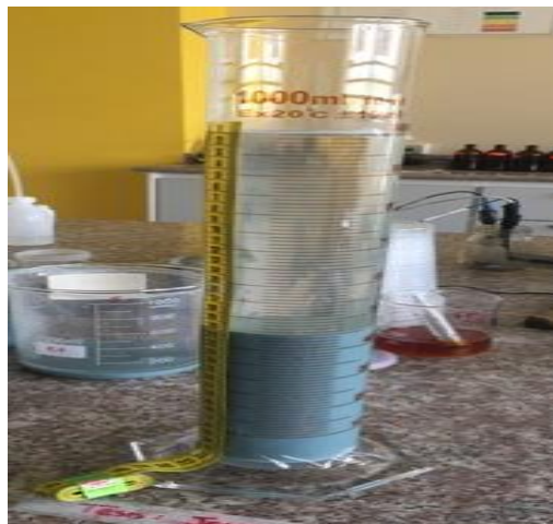
Fotografía 5-3: Cálculo del tiempo de retención hidráulica para el proceso de coagulación-floculación del agua residual de curtido.
