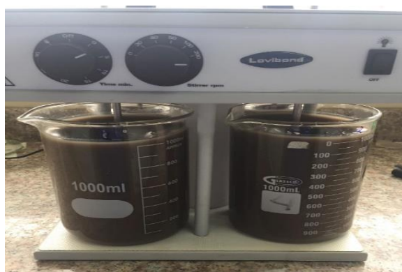
Fotografía 13-3: Selección de la velocidad óptima de agitación para el proceso de coagulación-floculación del agua residual de pelambre.
