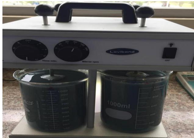
Fotografía 4-3: Selección de la velocidad óptima de agitación para el proceso de coagulación-floculación del agua residual de curtido.
