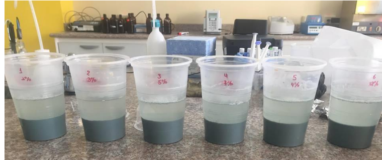
Fotografía 3-3: Selección de la dosis óptima de PAC para el proceso de coagulación-floculación del agua residual de curtido
