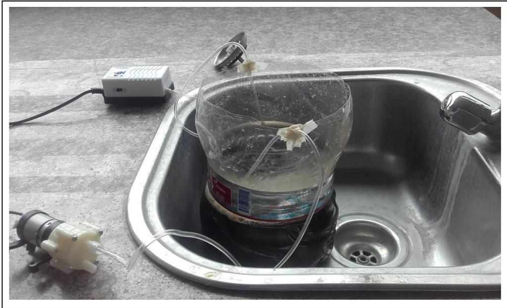
**Fotografía 5-3:** Aireación para muestra cruda de lixiviado, sin tratamiento previo de eliminación de sólidos.
