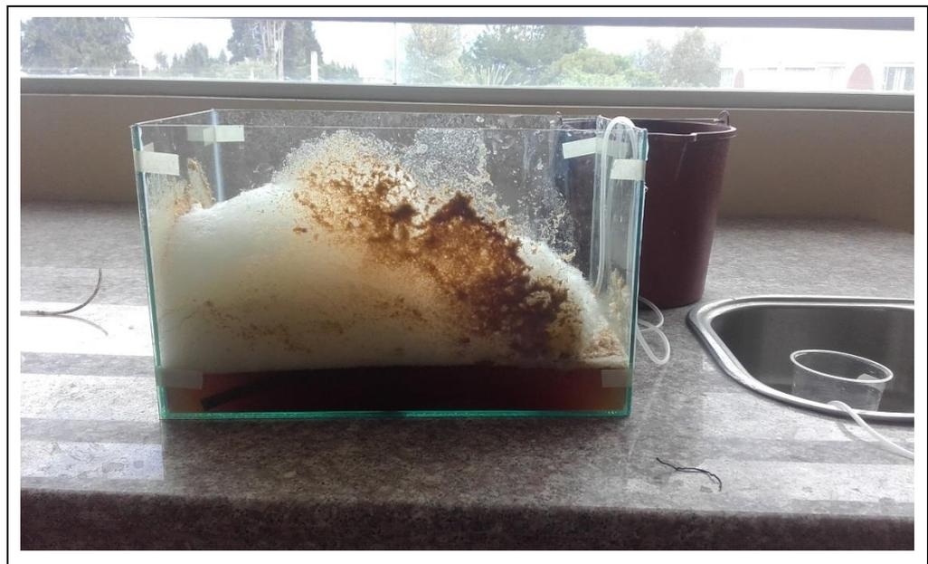
**Fotografía 7-3:** Aireación para muestra cruda de lixiviado, con tratamiento de sólidos “alternativa 1”.
