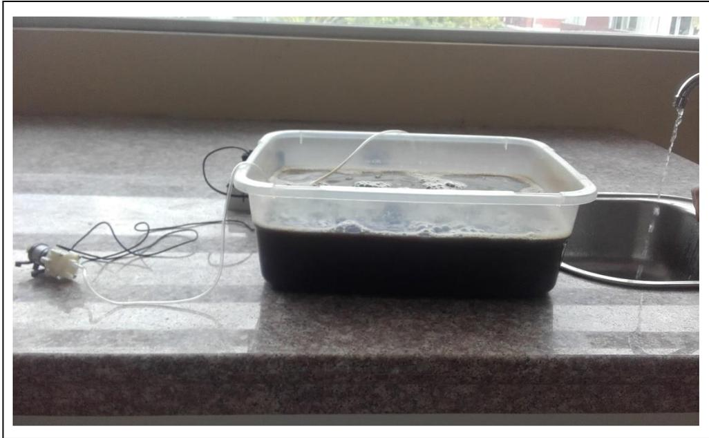
**Fotografía 6-3:** Aireación para muestra cruda de lixiviado, para realizar prueba de tratamiento de sólidos “alternativa 2”.
