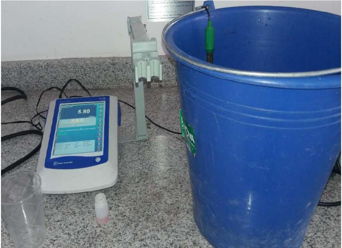
Medición del pH de la solución buffer.
