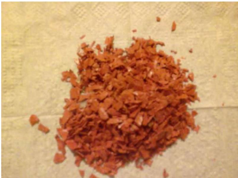
**Figura 2-4.** Retazos de cubiertas para techos (Muestra 2)
