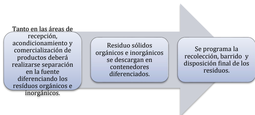
Figura 2: Diagrama general de la secuencia de los procesos de manejo de los residuos
