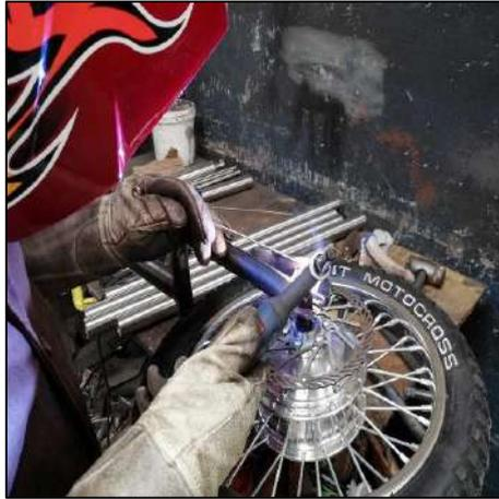
**Figura 25-3: Adaptación de soporte para sujetar la mordaza de freno.**
