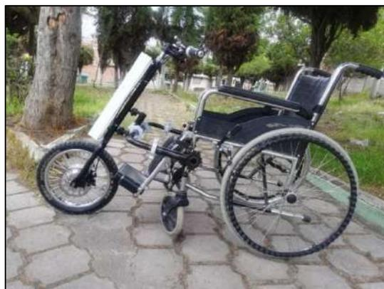
**Figura 6-3: Vista lateral del prototipo acoplado a una silla de ruedas.**
