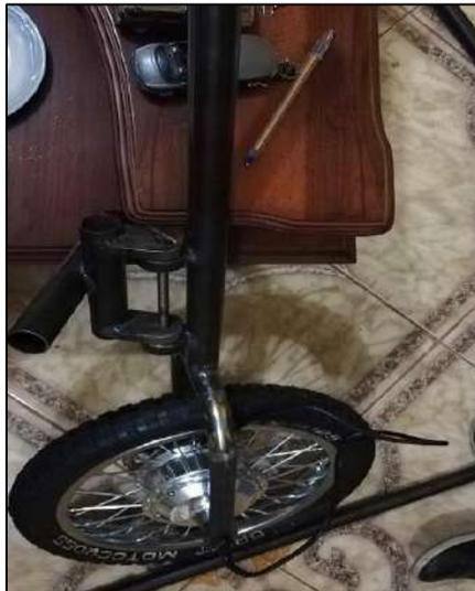
**Figura 24-3: Acople de la estructura principal de la rueda.**
