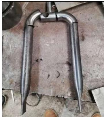
**Figura 14-3: Elemento para la construcción de la horquilla.**
