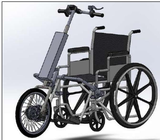
**Figura 1-3: Vista isométrica del sistema de propulsión acoplado a una silla de ruedas.**
