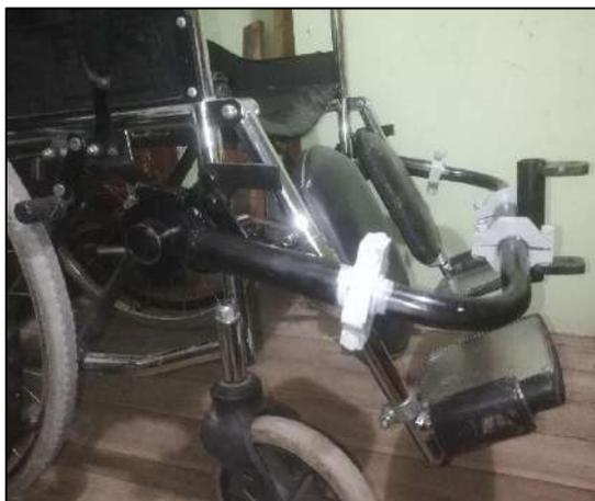
**Figura 37-3: Instalación de la barra central.**
