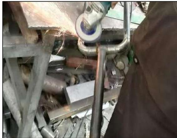
**Figura 16-3: Pulido de la estructura a manera de horquilla.**
