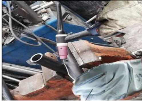
**Figura 21-3: Soldeo de la estructura en T.**
