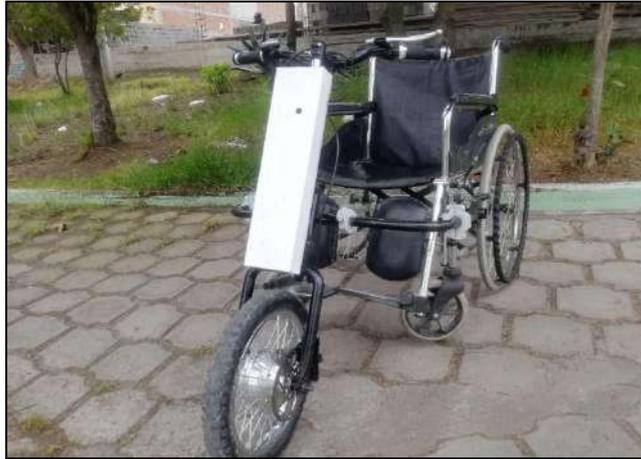
**Figura 38-3: Sistema de propulsión acoplado a la silla de ruedas.**
