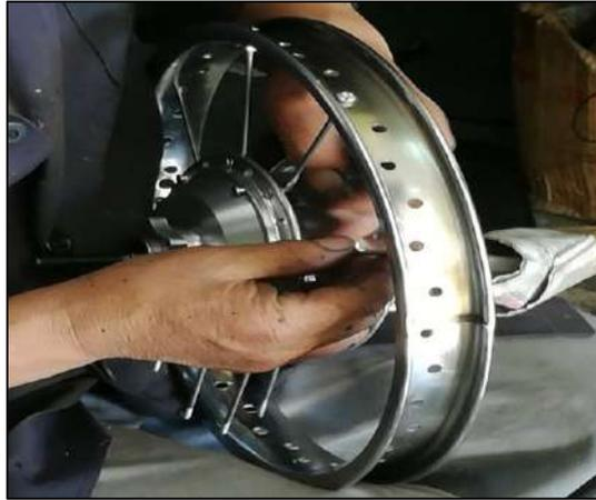
**Figura 13-3: Acople del motor eléctrico aro.**
