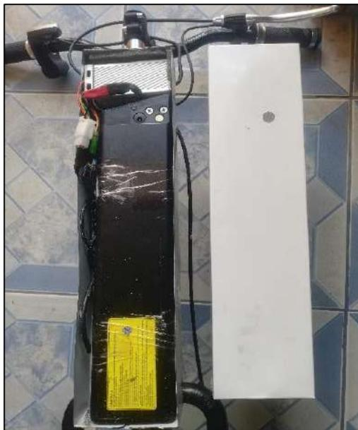
**Figura 28-3: Instalación del controlador y la batería.**
