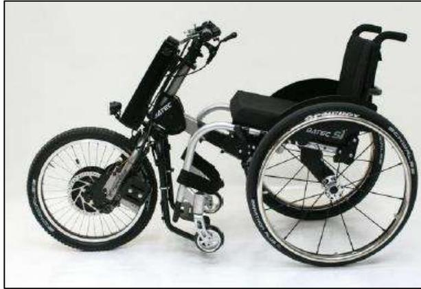
**Figura 5-2: Motorización con manillar Batec.**
