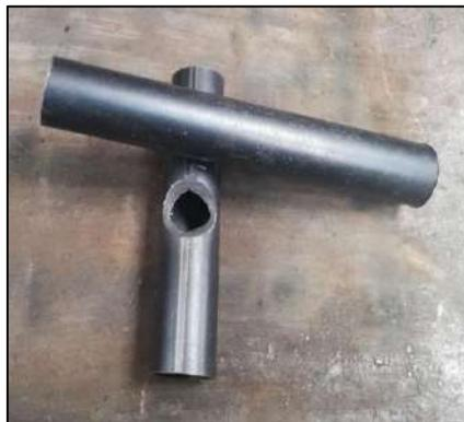
**Figura 20-3: Estructura en T para sujeción de los brazos del sistema.**
