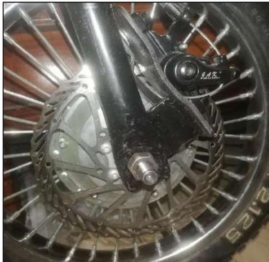
**Figura 26-3 Instalación del sistema de freno.**
