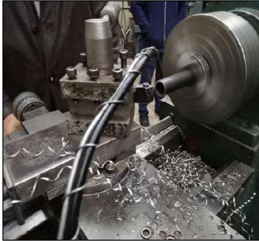
**Figura 17-3: Torneado del eje para soporte de la dirección.**
