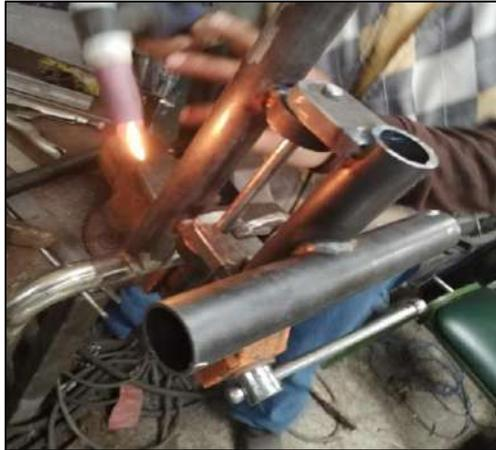
**Figura 23-3: Soldeo de los soportes.**
