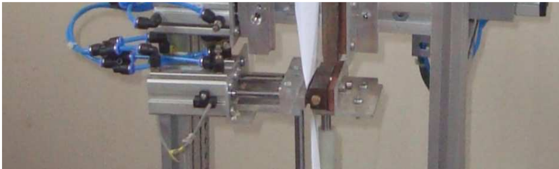
Figura III.11. Etapa de sellado horizontal
