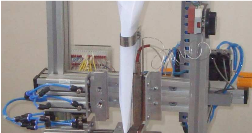
Figura III.10. Etapa de sellado vertical
