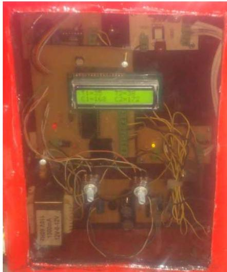
**Figura I.** Disposición de los mandos y control en el tablero principal.
