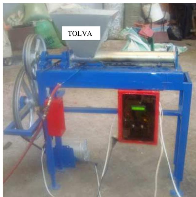
**Figura III.** Ubicación de la tolva en el prototipo
