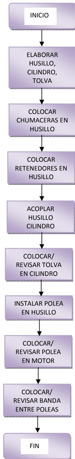
**Figura V.20** Procedimiento del montaje mecánico del prototipo
