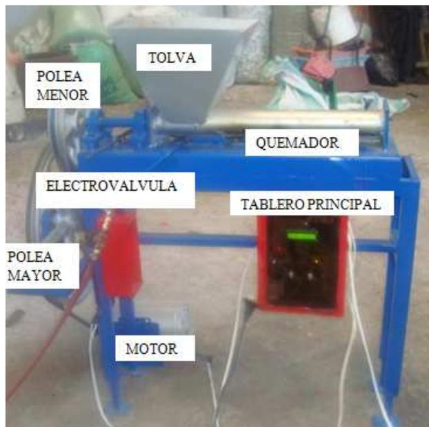
**Figura II.** Ubicación de los elementos principales en el prototipo.
