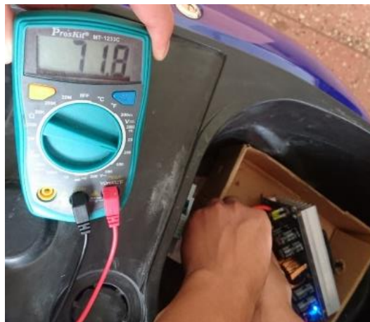
Figura 10-4: Estado inicial de Carga Baterías LiFePO4 Realizado por: Geovanny Daquilema
