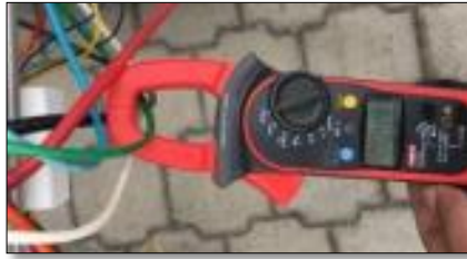
Figura 3-4: Medición de Amperaje Realizado por: Geovanny Daquilema
