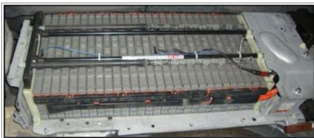
Figura 4-2: Celdas de Pack de batería de alta tensión de Níquel Metal Hidruro. Realizado por: (Espinosa Delgado, 2013)
