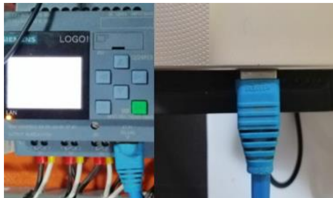
Figura 3-62: Comunicación entre la PC y el LOGO.
