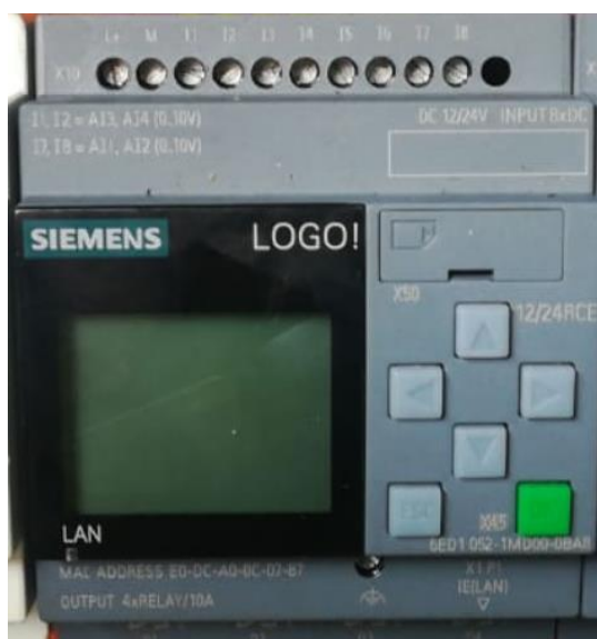
Figura 3-26: Relé programable SIEMENS
