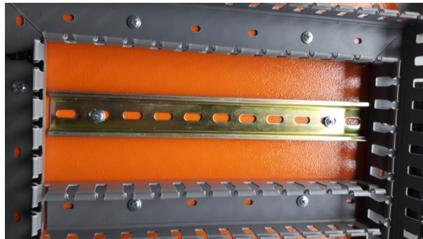
Figura 3-38: Ubicación del perfil en la bandeja. Fuente: Autores, 2019.
