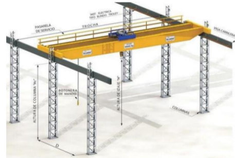
b) Mecanismo de sustentación propia para el puente grúa.
