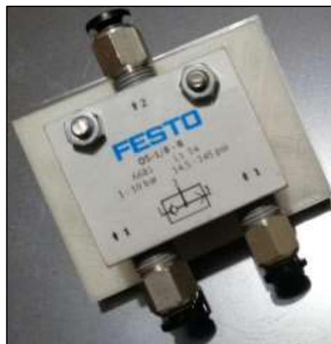
**Figura 3-5** Válvula neumática selectora
