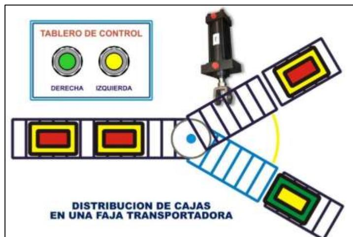
**Figura 3-22** Distribución de cajas en una cinta transportadora.
