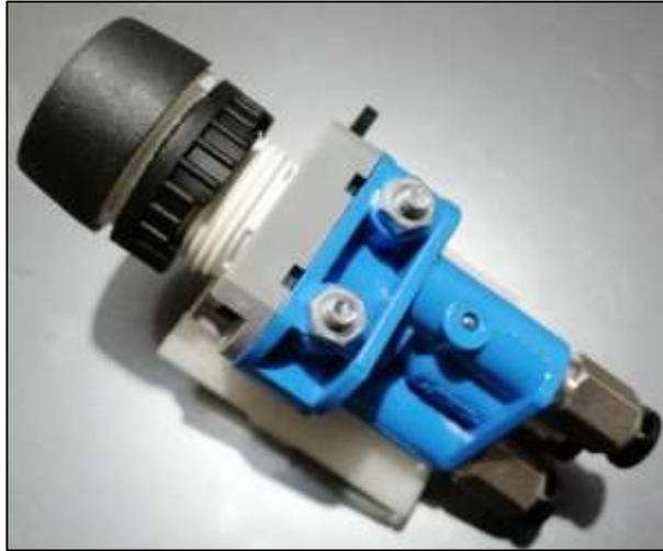
**Figura 3-6** Válvula 3/2 acción por esfuerzo muscular
