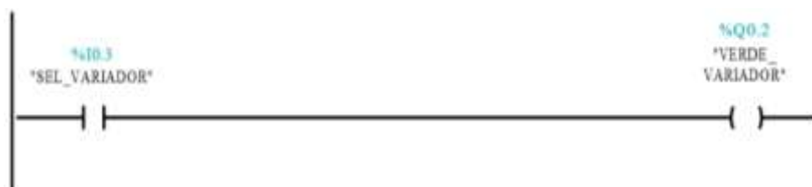
Figura 24-3: Encendido de la lámpara verde modo variador Realizado por: Autores
