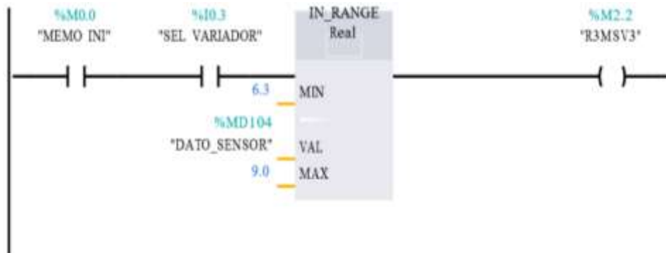
Figura 19-3. Rango 3 activación de la bomba a 45 Hz Realizado por: Autores
