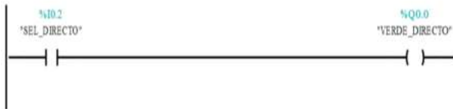
Figura 23-3: Encendido de la lámpara verde modo directo Realizado por: Autores
