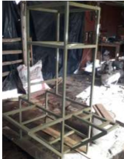
Figura 8-3: Estructura pintada con fondo automotriz Fuente: Autores
