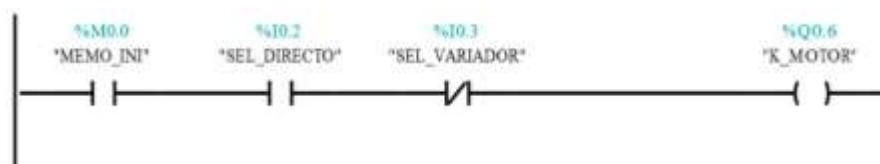
Figura 21-3: Activación del contactor modo directo Realizado por: Autores
