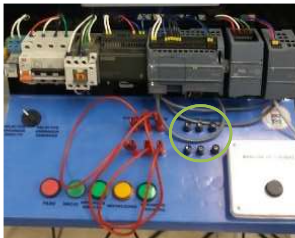
Figura 38-3: Terminales para el circuito de potencia en arranque por variador
