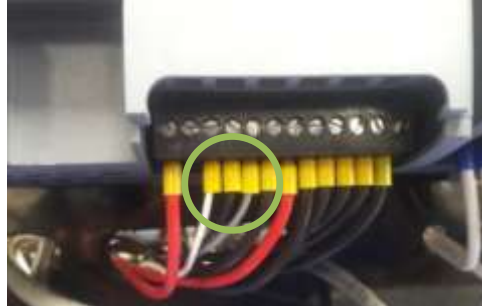
Figura 37-3: Conexión de las salidas digitales
