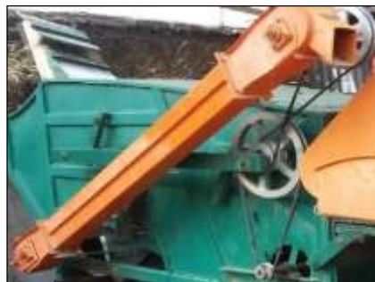
Figura 7-3: Elevador de panoja mal trillada
