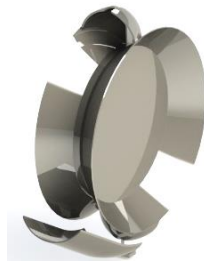
Figura 10-2: Sistema de Corte con Cuchillas y Sujeción Giratoria
