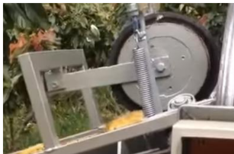
Figura 9-2: Corte de Mazorcas de Cacao Mediante Sierras
