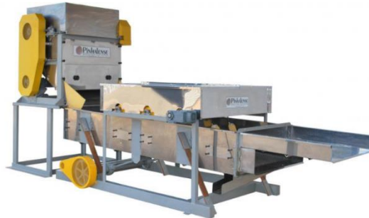
Figura 14-2: Despulpadora de Cacao con Zaranda Vibratoria
