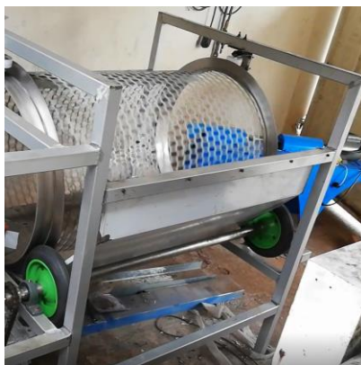
Figura 12-5: Construcción de Sistema de Despulpado
