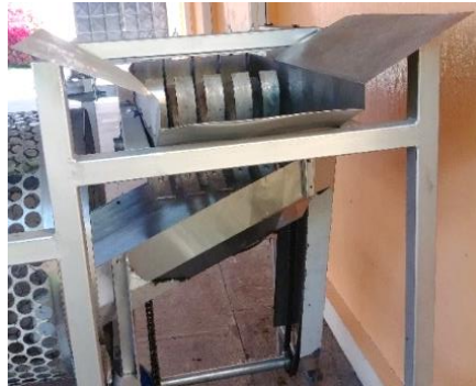
Figura 6-5: Construcción del Sistema Alimentación
