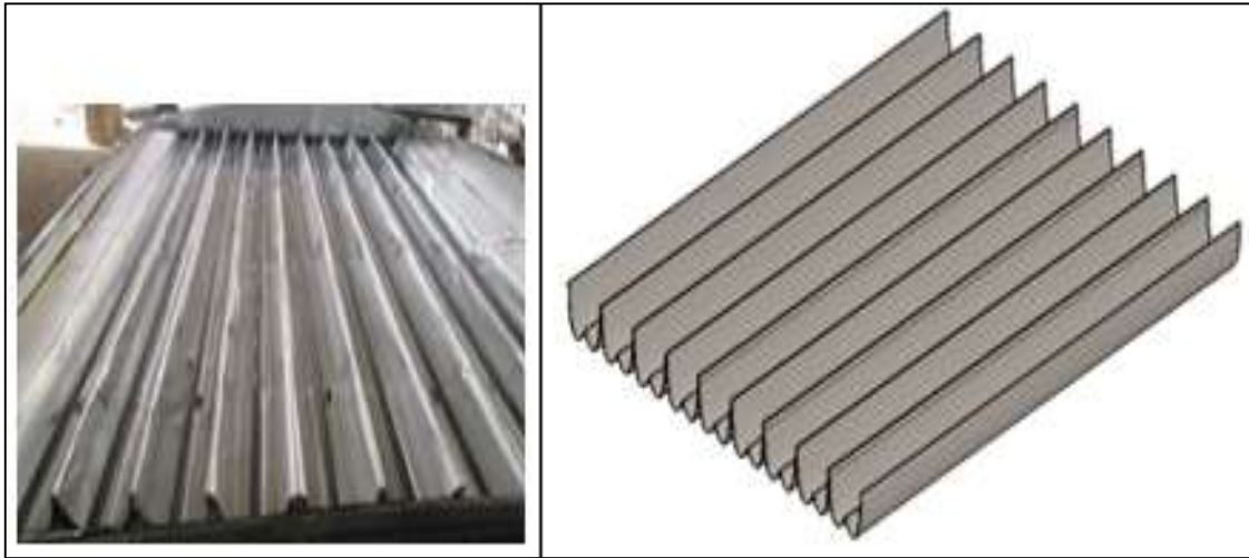
Figura 15-3: placa absolvedora de calor Fuente: Autores, 2019.
