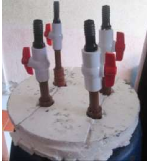
Figura 27-3: Válvulas del tanque plástico. Fuente: Autores, 2019
