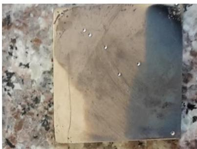
**Figura 30-3:** Probeta con los diferentes puntos de medición.
