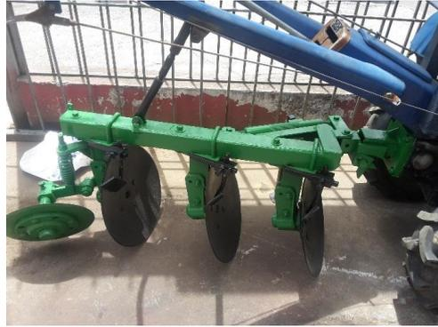
**Figura 63-3:** Acoplamiento del disco del arado al motocultor
