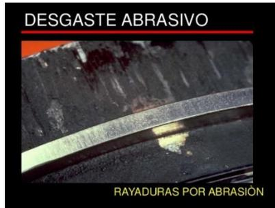
**Figura 14-2:** Rayaduras por abrasión.
