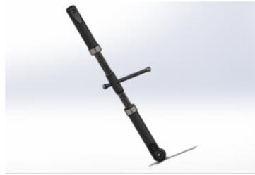
**Figura 61-3:** Barra T para eliminar vibraciones y variar profundidad del apero
