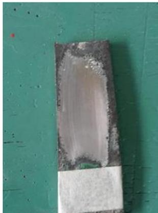
**Figura 7-3:** Desgaste abrasivo de la Probeta 2
