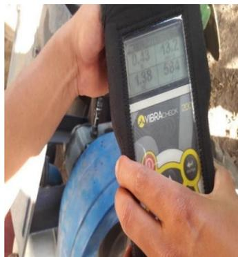
**Figura 52-3:** Datos de la polea de transmisión lado horizontal.
