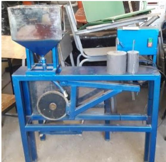
**Figura 20-2:** Máquina de abrasión.
