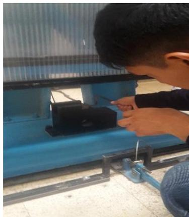
**Figura 34-3:** Colocación de la probeta al péndulo de Charpy.
