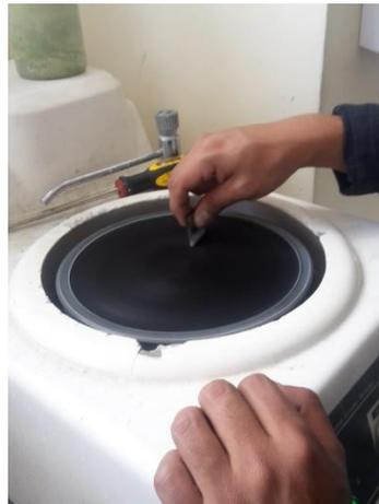
**Figura 23-3:** Pulido final de probeta.
