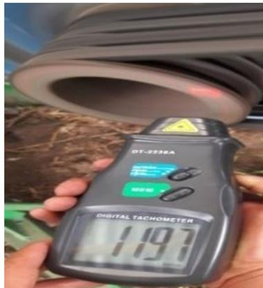
**Figura 48-3:** Rpm del motor
