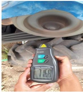
**Figura 49-3:** Rpm de la polea de transmisión.
