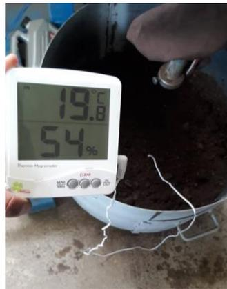
**Figura 16-3:** Medición de la humedad del suelo.
