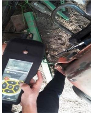
**Figura 51-3:** Datos de la polea del motor lado axial
