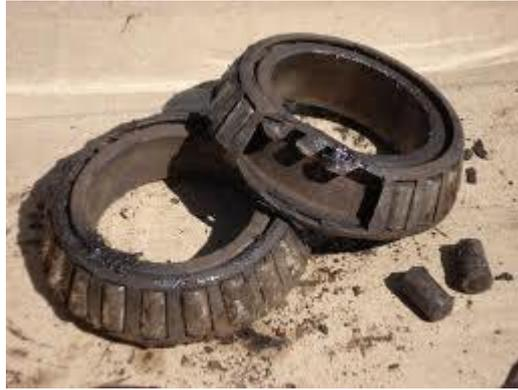
**Figura 16-2:** Desgaste por corrosión
