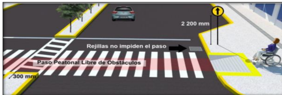
Ilustración 13-2: Dimensiones mínimas para las zonas que deben estar libres de obstáculos en un cruce peatonal Fuente: (NTE INEN 2246, 2015).
