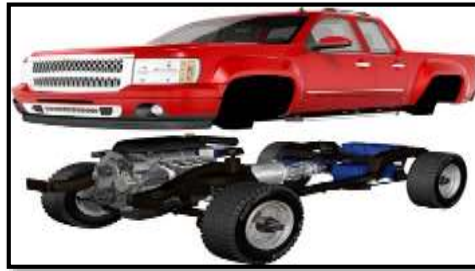
Figura 3-2: Carrocería y chasis separados
