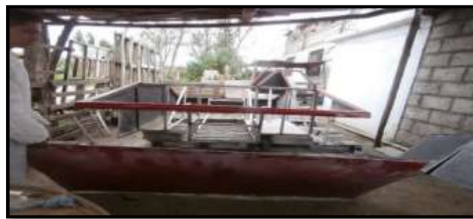
Figura 65-3: Remoción de la fibra de vidrio frontal
