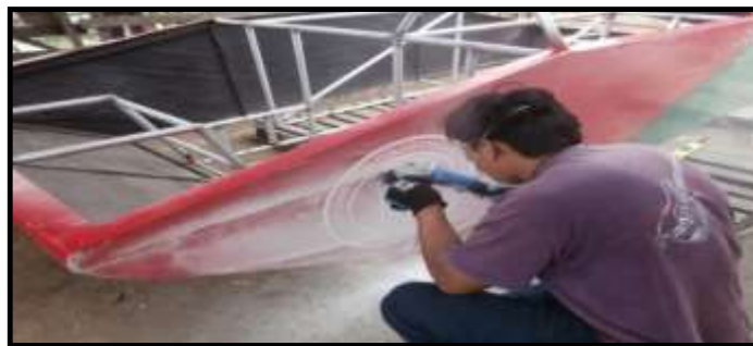
Figura 64-3: Remoción de la fibra de vidrio lateral
