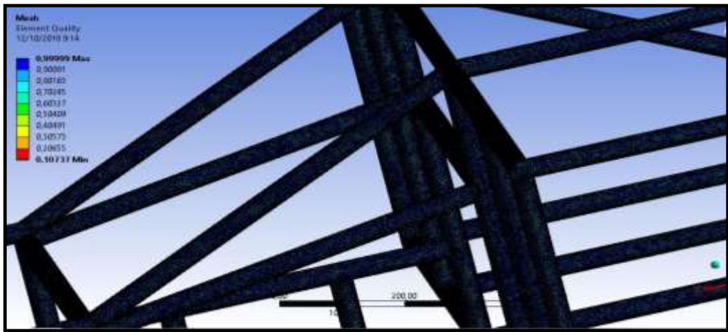
Figura 26-3: Mallado del Bastidor
