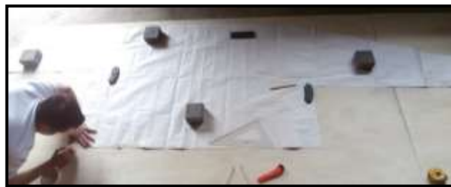
Figura 68-3: Trazado sobre la tabla triplex
