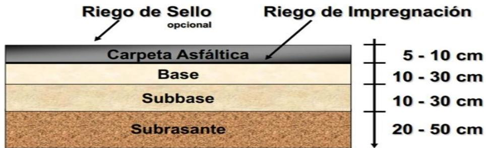
**Ilustración 9: Estructura Típica del pavimento flexible**
