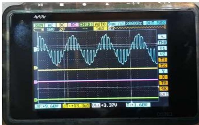
**Figura 5- 4:** Forma de onda del control Chopper o troceador
