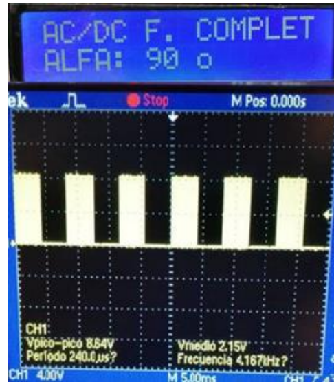
Figura 4- 12: Visualización del ángulo de disparo 90^\circ y onda de control.
