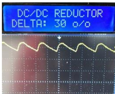
Figura 4- 25: Visualización del ancho de pulso 30% y forma de onda con una carga inductiva (motor universal).
