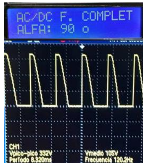
Figura 4- 13: Visualización del ángulo de disparo 90^\circ y forma de onda con una carga resistiva de 100W (foco).
