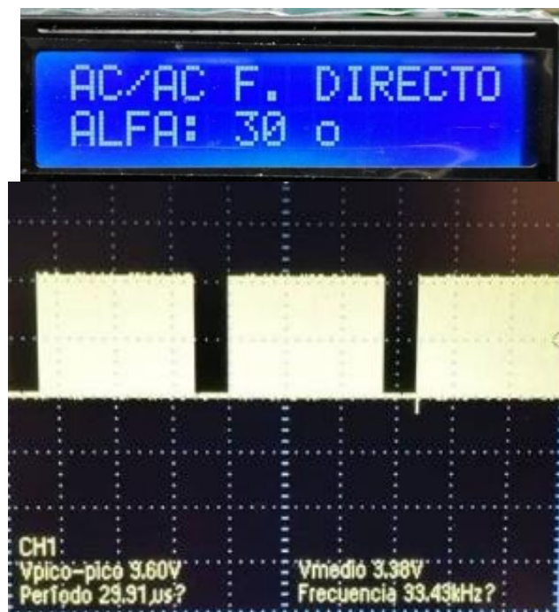
Figura 4- 1: Visualización del ángulo de disparo 30^\circ y onda de control.
