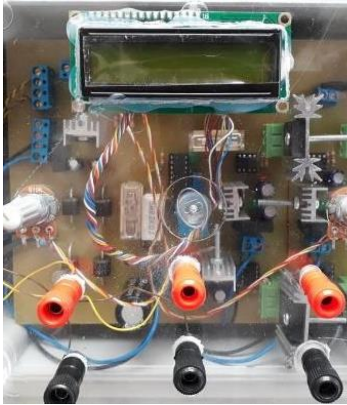
Figura 3- 38: Ensamblado del conversor dc/ac. Fuente: Asqui, Y; Chiluisa, F
