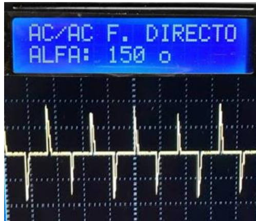
Figura 4- 6: Visualización del ángulo de disparo 150^\circ y forma de onda con una carga resistiva de 100W (foco).
