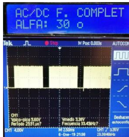
Figura 4- 10: Visualización del ángulo de disparo 30° y onda de control.
