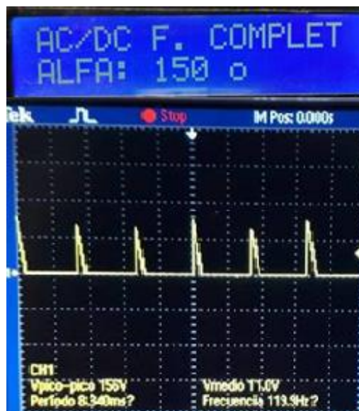
Figura 4- 15: Visualización del ángulo de disparo 150° y forma de onda con una carga resistiva de 100W (foco).
