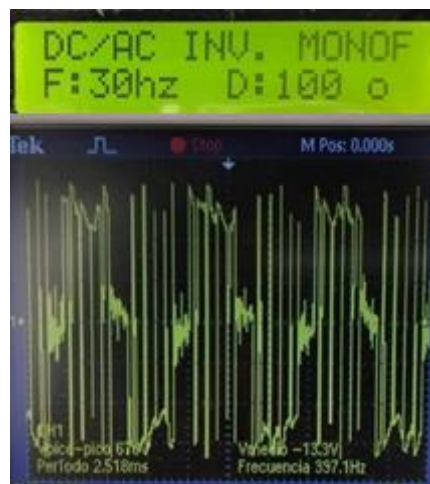
Figura 4- 34: Visualización de la frecuencia seleccionada de 30Hz. y onda con una carga inductiva (motor universal).
