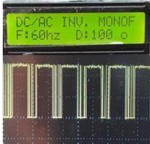
Figura 4- 32: Visualización de la frecuencia seleccionada de 60Hz y onda de control.
