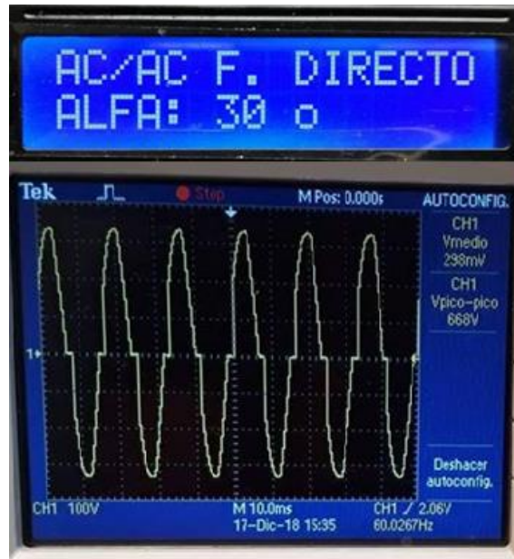
Figura 4- 2: Visualización del ángulo de disparo de 30° y forma de onda con una carga resistiva de 100W (foco).
