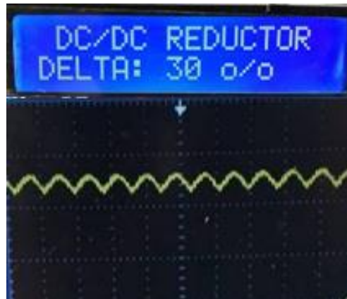
Figura 4- 20: Visualización del ancho de pulso 30% y forma de onda con una carga resistiva de 100W (foco).
