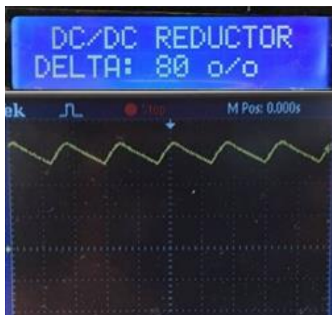
Figura 4- 24: Visualización del ancho de pulso 80% y forma de onda con una carga resistiva de 100W (foco).
