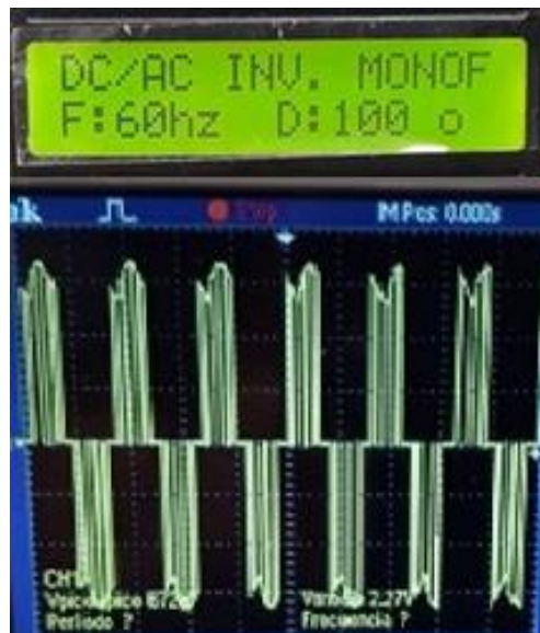
Figura 4- 33: Visualización de la frecuencia seleccionada de 60Hz. y forma de onda a una carga resistiva de 100W (foco).
