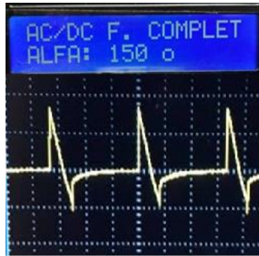
Figura 4- 18: Visualización del ángulo de disparo de 150° forma de onda con una carga inductiva (motor universal).
