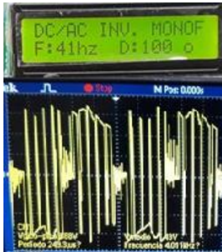
Figura 4- 35: Visualización de la frecuencia seleccionada de 41Hz. y carga inductiva (motor universal).
