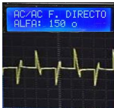
Figura 4- 9: Visualización del ángulo de disparo 150^\circ y forma de onda con una carga inductiva (motor universal).
