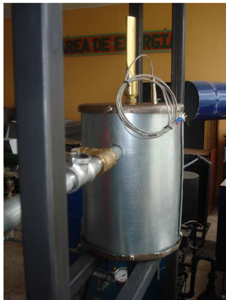
Figura 4.5: Cámara de acumulación de vapor
