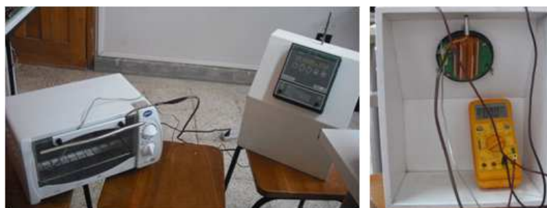
Figura 3.32: Calibración de la termocupla con el indicador de temperatura
